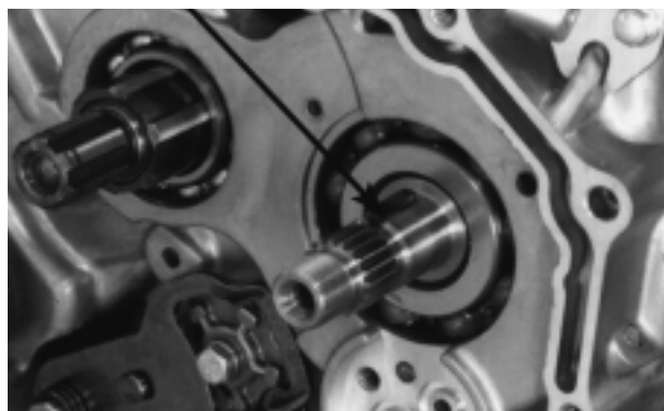
ENGRENAGEM MOTORA PRIMÁRIA CHAVETA WOODRUFF
